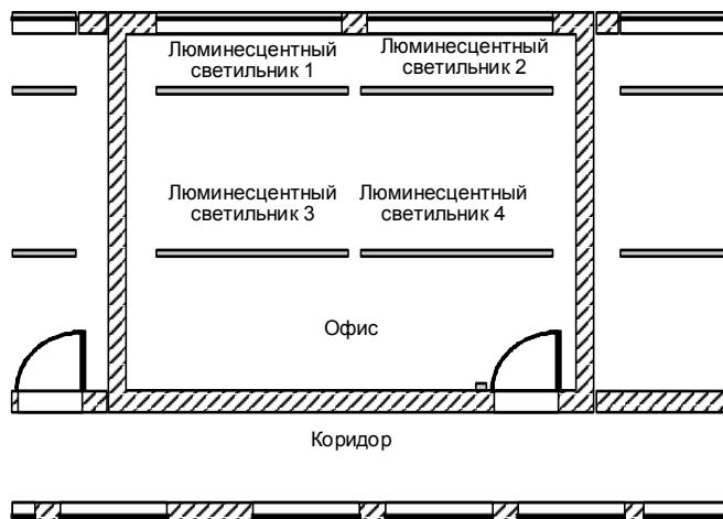
При проектировании систем освещения для промышленных помещений тип и количество используемых ламп зависит от требуемого уровня освещенности. В целях экономичности часто используют люминесцентные лампы, размещаемые рядами из трубок. Они подключаются группами в соответствии с тем, как используется помещение.
